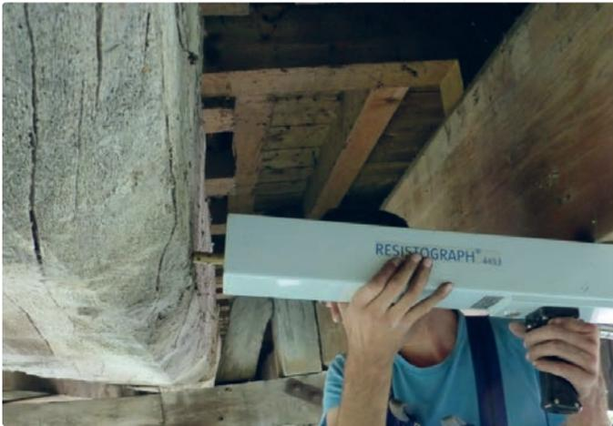
Die Beurteilung eines Bohrwiderstandsprofils setzt genaue Kenntnisse über den verbauten Holzquerschnitt, über die Holzanatomie und zu den Schadensbildern der jeweiligen Schädlinge voraus.
