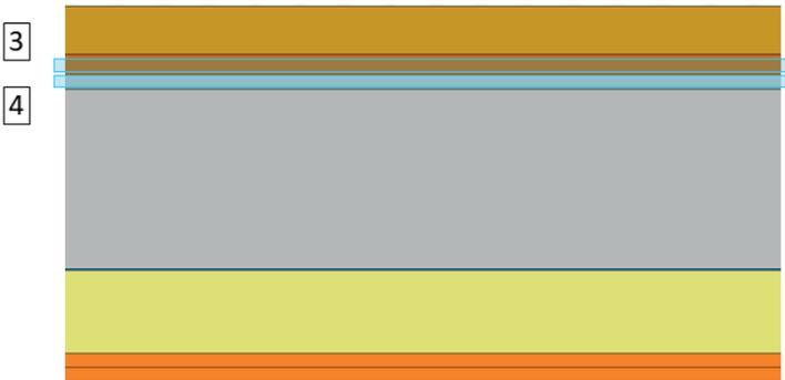
**B 22 Steildach mit Holzfaserdämmung**
